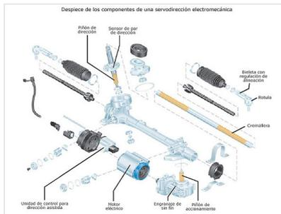
En la dirección asistida electromecánica cuenta con doble piñón. Se aplica la fuerza necesaria para el mando de la dirección a través de uno de los piñones llamado "piñón de dirección" y a través del otro piñón llamado "piñón de accionamiento". El piñón de dirección transmite los pares de dirección aplicados por el conductor y el piñón de accionamiento transmite, a través de un engranaje de sin fin, el par de servoasistencia del motor eléctrico para hacer el gobierno de la dirección más fácil.
