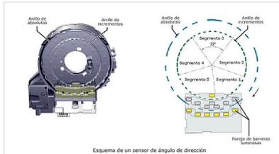
Si por simplificar la explicación se contempla solamente el anillo de incrementos, se aprecia por un lado del anillo la fuente luminosa y por el otro el sensor óptico (figura inferior).
